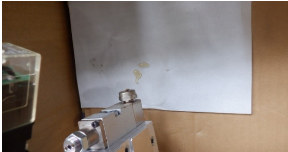
接着剤を吐出している状態① (スパイラルでは、有りません)
